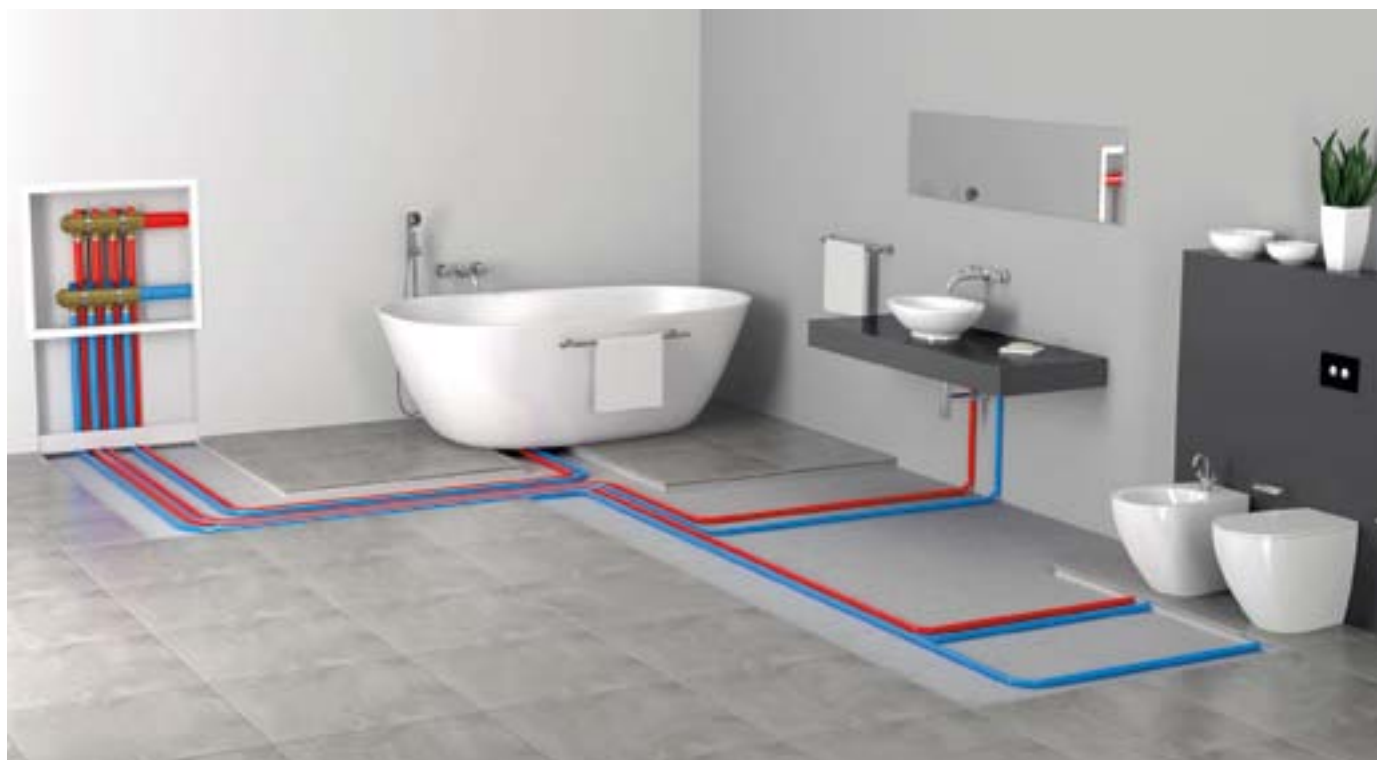
System wody użytkowej wykonany z izolowanych rur wielowarstwowych lub zabezpieczonych kolorowym peszlem.
